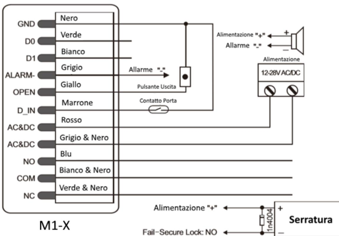
**ATTENZIONE:** Nel caso in cui si utilizzi un alimentatore comune fra l'iAccess M1-X e l'elettro serratura è **OBBLIGATORIO** installare un diodo 1N4007 o equivalente in quanto, in caso contrario, il lettore potrebbe essere danneggiato (il diodo 1N4007 è incluso nella scatola).
