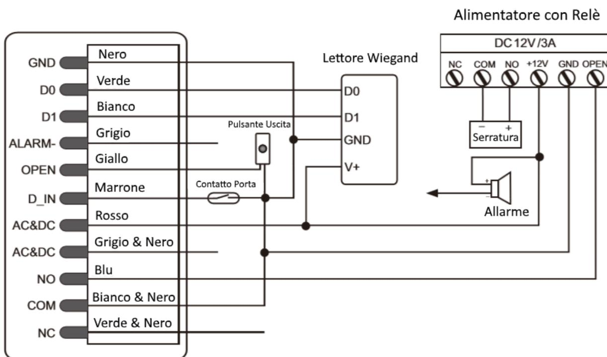
**ATTENZIONE:** Nel caso in cui si utilizzi un alimentatore comune fra l'iAccess M1-X e l'elettroserratura è **OBBLIGATORIO** installare un diodo 1N4007 o equivalente in quanto, in caso contrario, il lettore potrebbe essere danneggiato (il diodo 1N4007 è incluso nella scatola).
