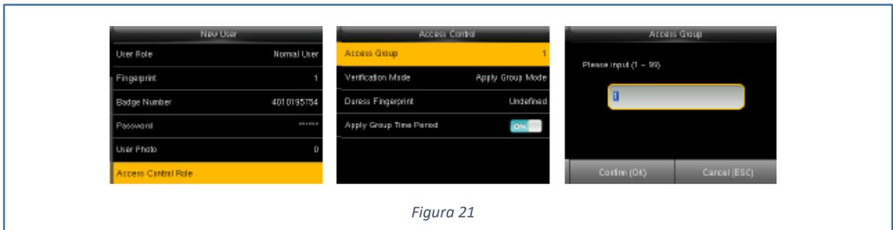
Le opzioni di controllo accesso servono per configurare gli accessi a porte per tutti, per sottogruppi, usando delle time zone.
