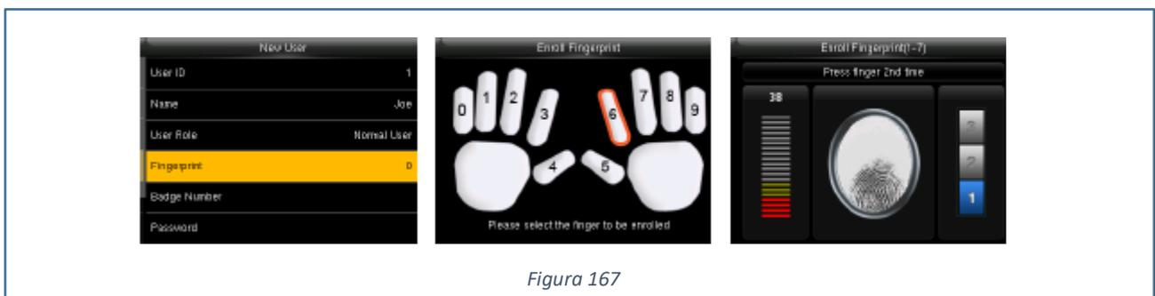
Selezionare tramite indicazione numerica l'impronta delle mani e posizionarla sul sensore 3 volte, è importante che la qualità dell'impronta sia sulla scala di colore verde. La verifica di corretta memorizzazione avviene mediante il seguente messaggio.
