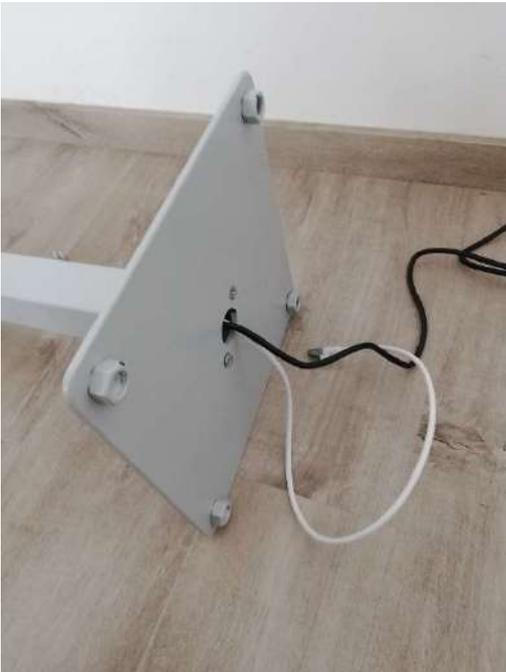
5. Prelevare lo ScanFACE e fare passare il cavi nel foro del coperchio e subito dopo all'interno della ghiera di fissaggio dello ScanFACE e stringere la ghiera.
