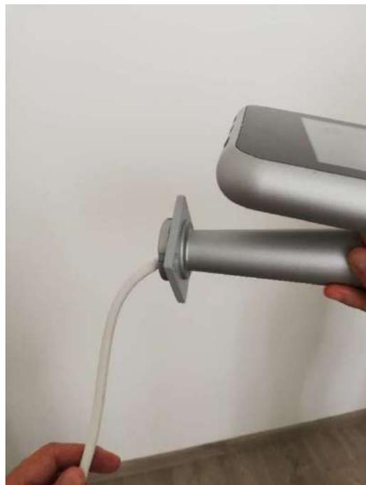
6. Collegare l'alimentazione e il cavo di rete al cablaggio dello ScanFACE
