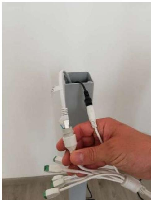
7. Inserire i cavi all'interno del corpo della piantana e fissare con le rimanenti viti del coperchio.
