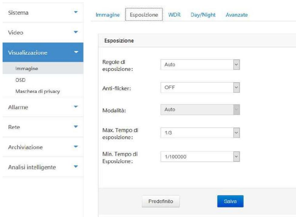
**Nel caso in cui l'immagine dello ScanFACE sia scura per motivi di illuminazione abilitare in Regole di Esposizione: Compensazione con Retroilluminazione.**
