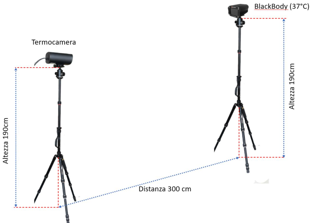
Per una corretta rilevazione è necessario posizionare il blackbody ad una distanza di 300 cm dalla termocamera ScanVision, entrambi ad una altezza di 190 cm.
